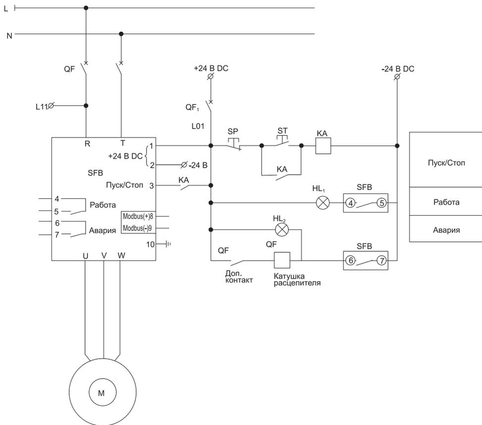
Рисунок Б.4 — Пример схемы подключения однофазного УПП с платой управления с питанием 24 В DC
