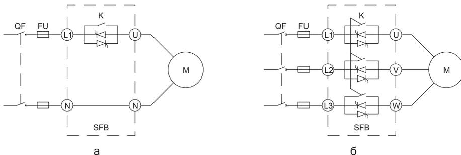
Рисунок 4 — Схема силовой цепи: а) для моделей с однофазным питанием; б) для моделей с трехфазным питанием, где: QF — выключатель нагрузки, FU — предохранитель, К — электромеханическое реле встроенного байпаса.
