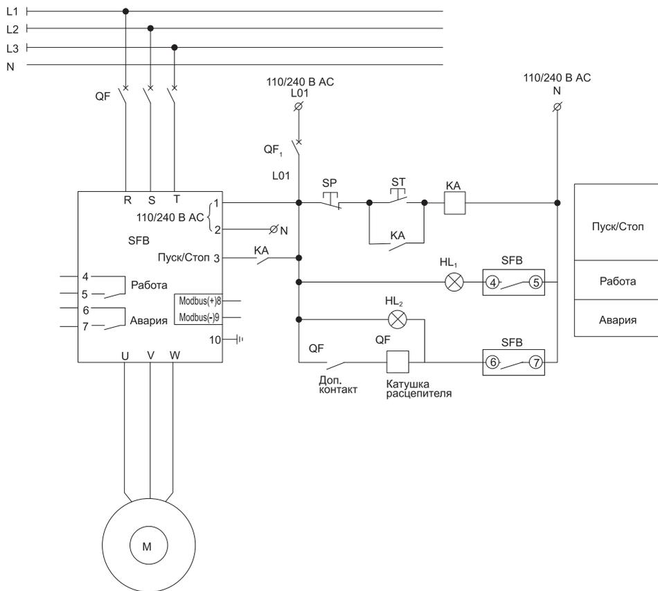
Рисунок Б.1 — Пример схемы подключения трехфазного УПП с платой управления с питанием  $100 \div 240$  В AC
