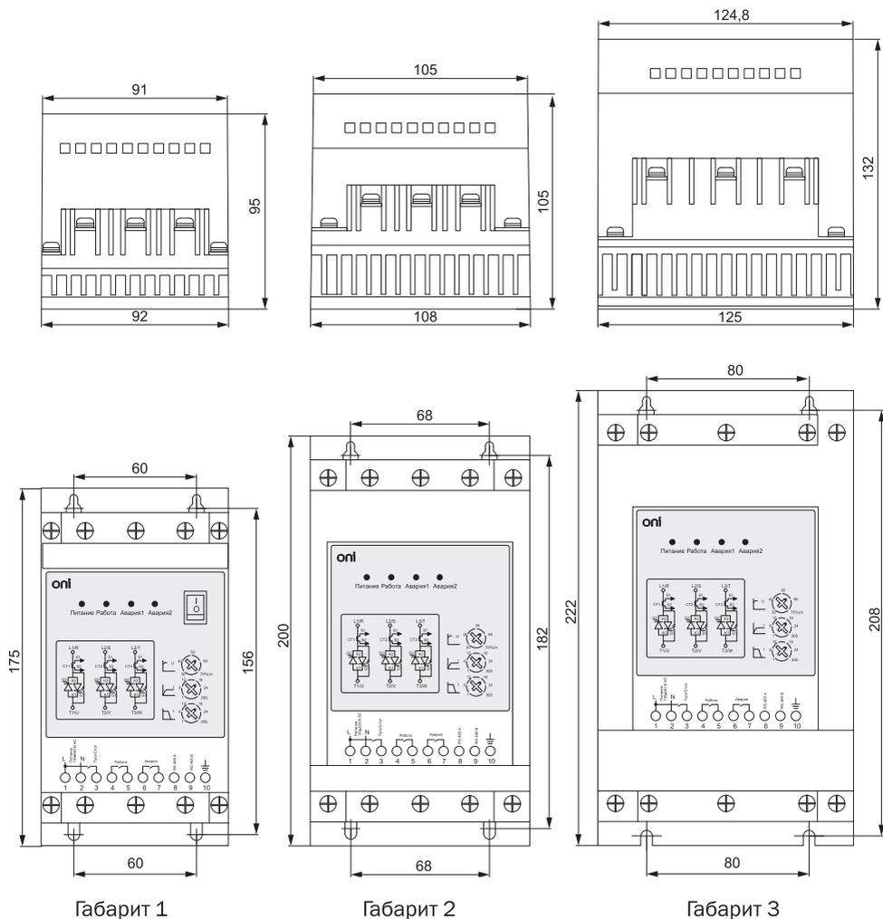
Рисунок 2 — Габаритные размеры устройств плавного пуска
