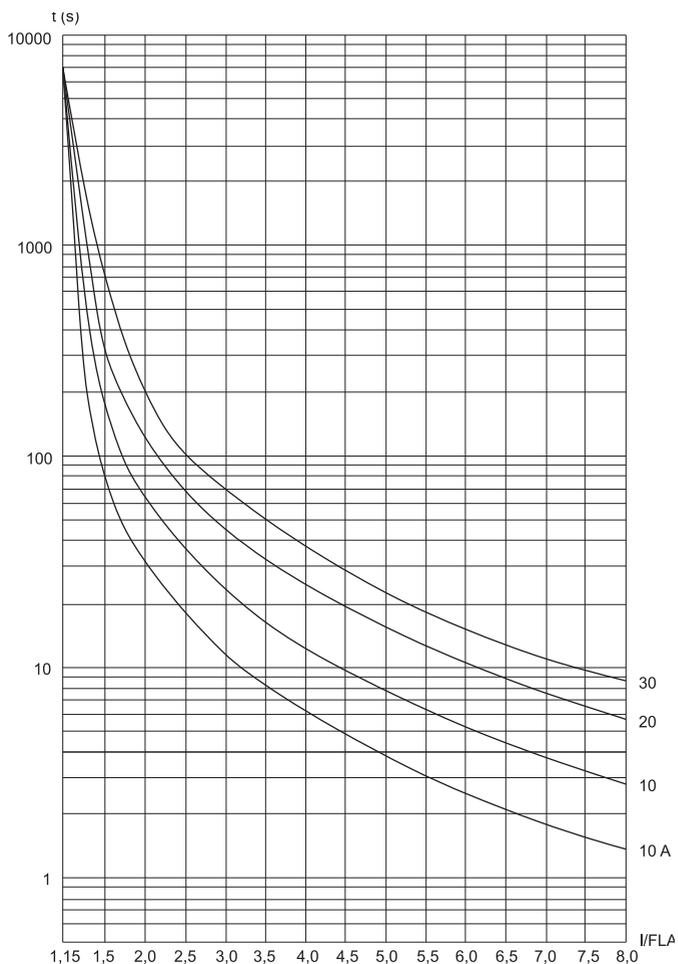
Рисунок 10 — Диаграмма времени срабатывания защиты от перегрузки
