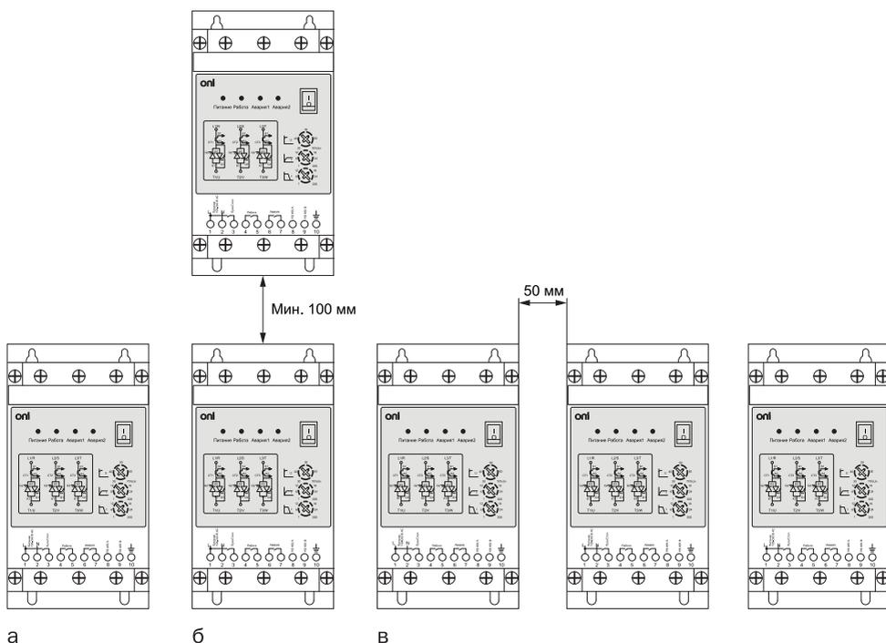
Рисунок 3 — Установка устройств: а) одиночная; б) групповая вертикальная; в) групповая стенка к стенке
