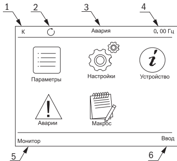
Рисунок 4.9 – Индикация на пульте управления
